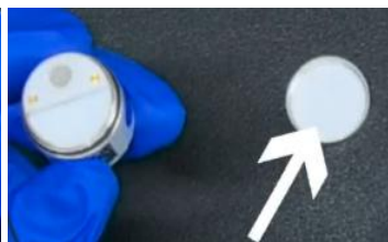
图 2：上盖内测的 PTFE 滤膜
